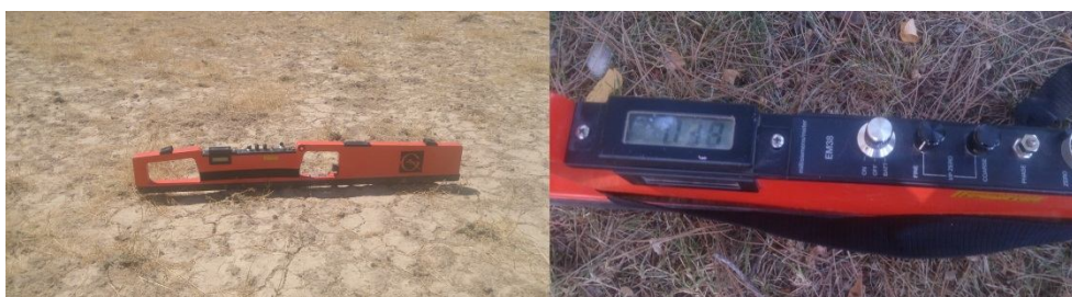
شکل ۴- القاگر الکترومغناطیس استفاده شده در این مطالعه (EM38).
