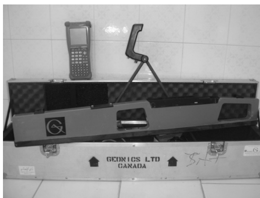
شکل ۳- نمایی از دستگاه القاگر الکترومغناطیس از نوع EM-38 و ساخت شرکت ژئونیکس کانادا.
