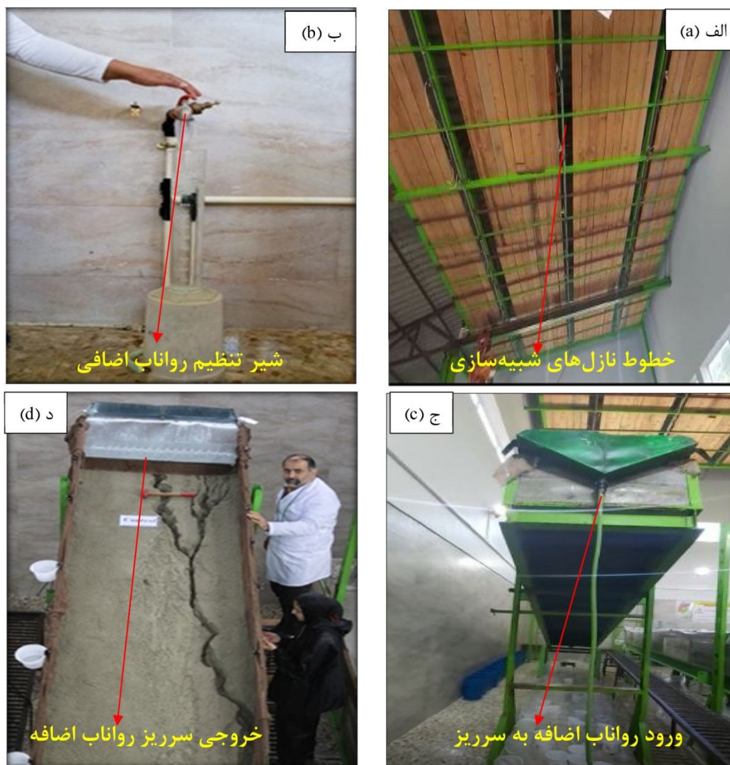
شکل ۱- سامانه شبیه‌ساز باران (الف)، شیر تنظیم رواناب اضافه (ب)، ورودی رواناب اضافه به سرریز (ج) و خروجی سرریز رواناب اضافه (د).
