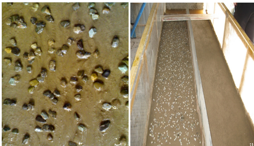
شکل ۱- الف) توزیع یکنواخت سنگ ریزه ها بر روی سطح خاک و ب) بعد از اتمام آزمایش.
